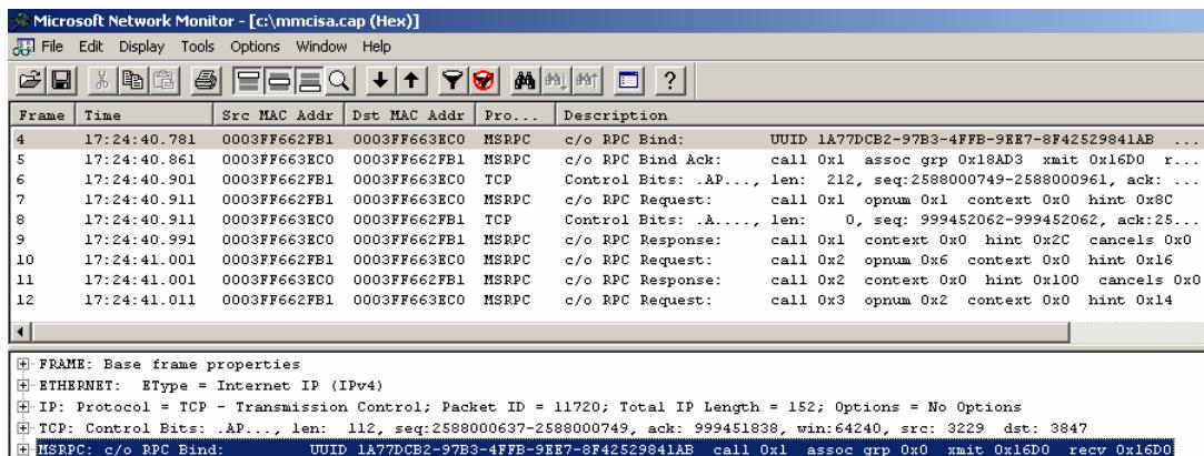
En regardant cette capture, on voit clairement apparaître le dialogue sur le port 135 (RPC Bind) visant à déterminer le port utilisé par le service distant. On identifie alors clairement l'UUID utilisée par la MMC ISA :
