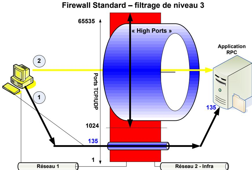
Comme vous pouvez le voir sur ce schéma, le firewall de niveau 3 ouvre un nombre impressionnant de ports (le gros tuyau bleu), simplement car il ne peut jamais savoir quel va être le port utilisé par le service RPC distant.
